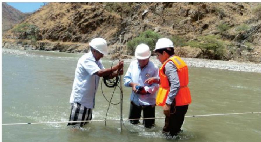
Personal de Hidrometeorología a cargo de las estaciones hidrométricas y meteorológicas con las que cuenta el Proyecto Especial Olmos Tinajones, realizó pruebas de funcionamiento de seis nuevos correntómetros electromagnéticos, cuyo uso permite conocer con precisión los caudales en  $m^3/s$  de los ríos en estudio para los fines del Proyecto Olmos.
